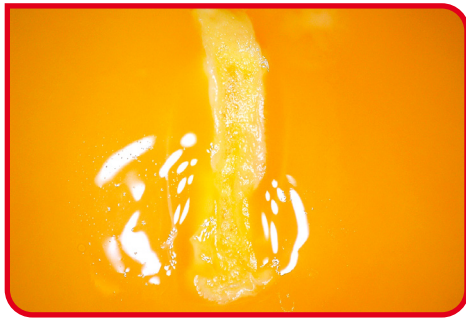
Fig. 5: Un exemple de mauvaise forme de coagulation, de mauvaise netteté des bords et d'homogénéité médiocre
