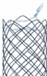
Suture de l'extraction à l'extrémité proximale du stent
